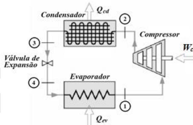
I – Processo 1-2: O vapor entra no compressor, onde é comprimido e bombeado, tornando-se vapor superaquecido.
